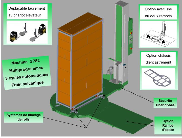
**Fonctionnement :** Placez le roll sur le plateau tournant, accrochez le film. Après avoir fait les réglages, appuyez sur le bouton de démarrage du cycle, le cycle se déroule automatiquement, lorsque le banderolage est terminé et que le plateau est arrêté, coupez le film et évacuez le roll.
